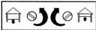
Limit Adjustment Screws Vis de réglage de fin de course Tornillos de regulación de recorrido
