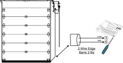
Figure 22 - Electric Reversing Edge
